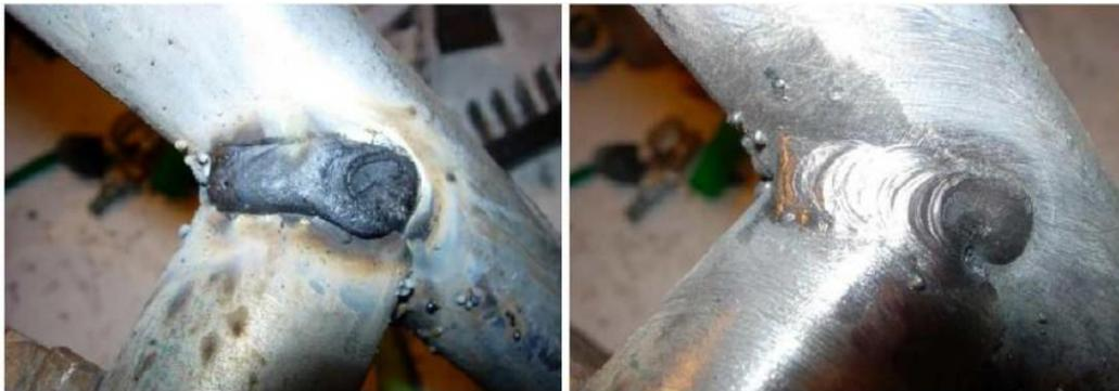
Figure 3 : Soudure BIEN réalisée. A gauche, avec laitier. A droite, une fois le laitier retiré.
